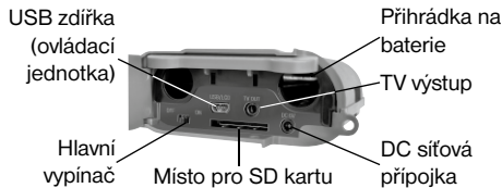
Obr. 2: Rozhraní a přihrádka na baterie
