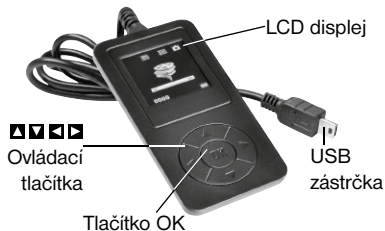
Obr. 2: Rozhraní a přihrádka na baterie
