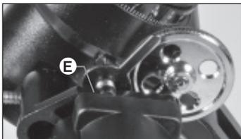
Le couplage (E) est desserré quand il est positionné comme indiqué. Le fonctionnement du moteur peut démarrer.
