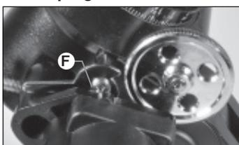
Le couplage (F) est fermé quand il est positionné comme indiqué. L'axe d'ascension droite peut être déplacé manuellement.
