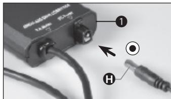
Branchez la fiche coaxiale (H) du compartiment de la batterie dans la prise de la raquette de commande (1) avant de commencer l'opération.
