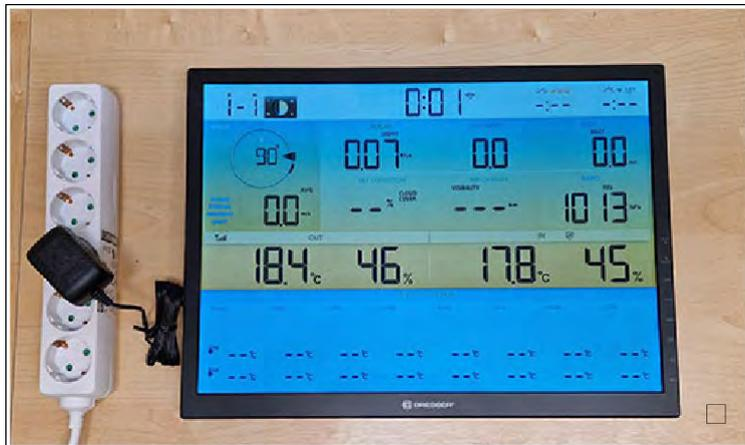
13. Drücken Sie die Taste Sensor/WIFI auf der Rückseite der Basisstation **länger als 6 Sekunden** bis in der Anzeige "AP" zu blinken beginnt.
