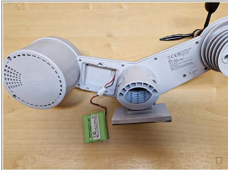
10. Verschließen Sie das Batteriefach wieder
