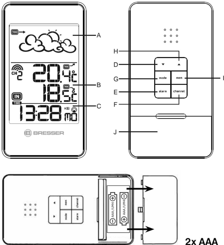
**A. METEO** Fenêtre**B. TEMPERATURE** Fenêtre**C. HORLOGE** Fenêtre**D. (▼) (DOWN) (VERS LE BAS)** Touche
