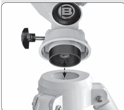
Abb. 5: Aufsetzen der Montierung auf das Stativ
