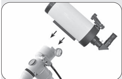
Abb. 8a: Optik-Tubus mit der Prismenschiene in die Prismenaufnahme einsetzen und fixieren.
