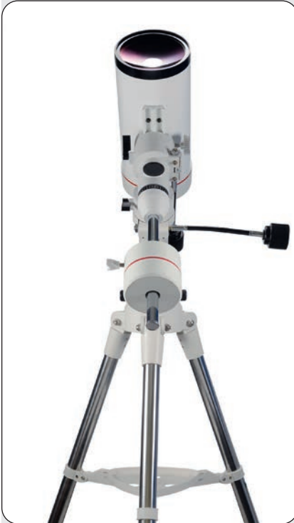
Figura 18b: La posición de inicio de la paralización vista desde el norte.
