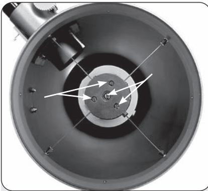
Fig. 31b : Les quatre vis de collimation dans le boîtier du miroir secondaire
