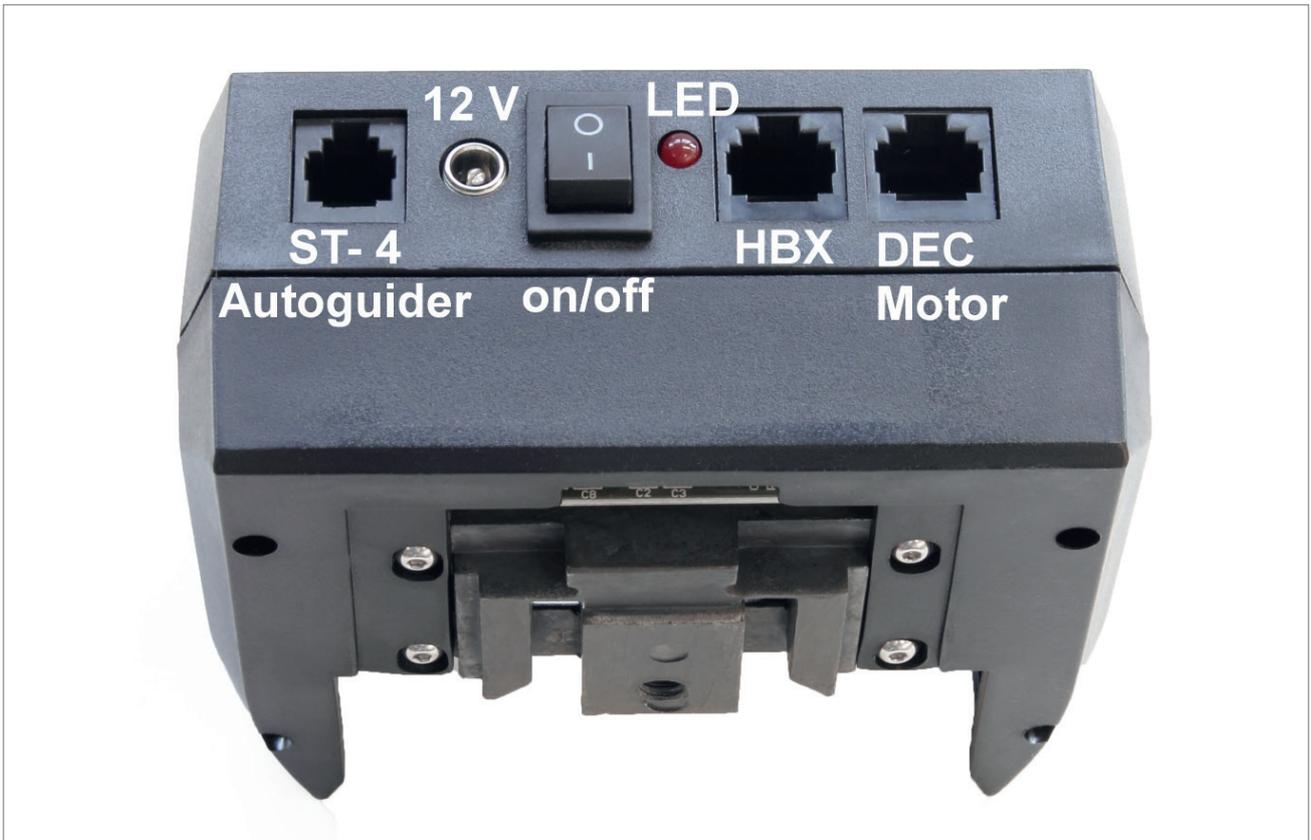
Abb. 1b: Das Anschlussboard des RA-Motors
