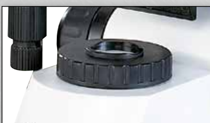
Blende für Köhlersche Beleuchtung Diaphragm for Köhler-illumination
