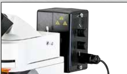
100 W Quecksilber-Höchstdrucklampe 100 W extreme high pressure mercury lamp
