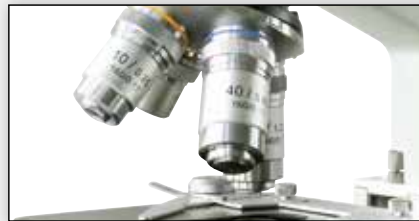
Achromatische DIN-Objektive Achromatic DIN-objectives
