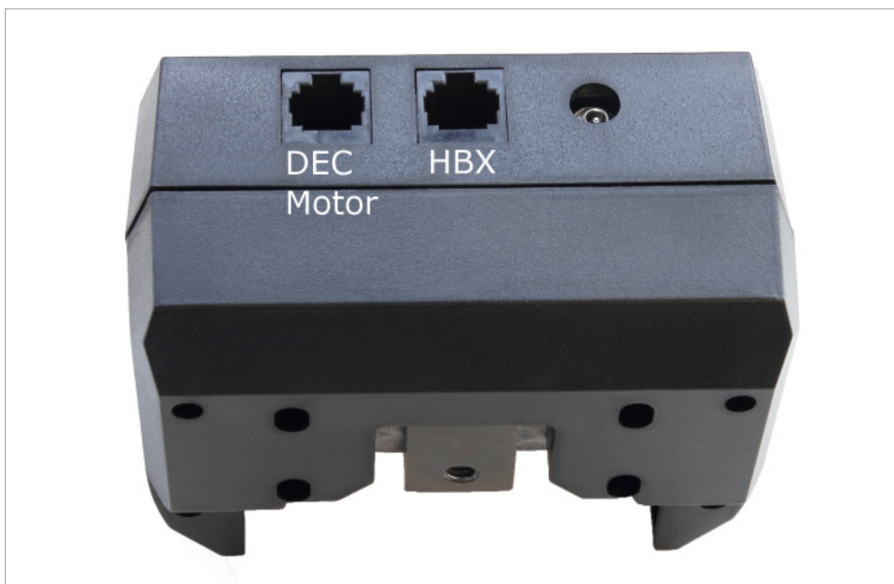
Fig. 1c: Panneau de contrôle du moteur DEC
