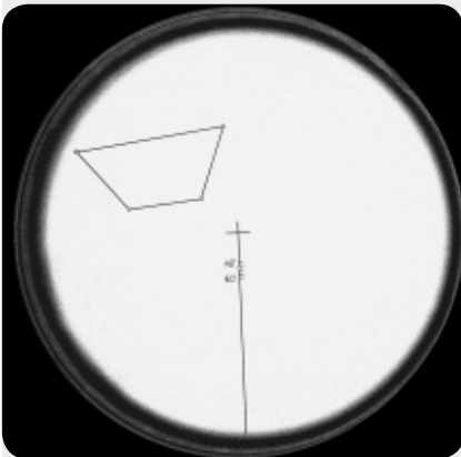
Fig. 5: Représentation du réticule interne du viseur polaire d'alignement (les quatre étoiles montrent une association près du pôle sud céleste)
