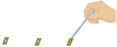
5. Warte einige Minuten und vergleiche die Farben mit der pH-Skala. Ermittle mithilfe der Farben den pH-Wert jeder Probe.
