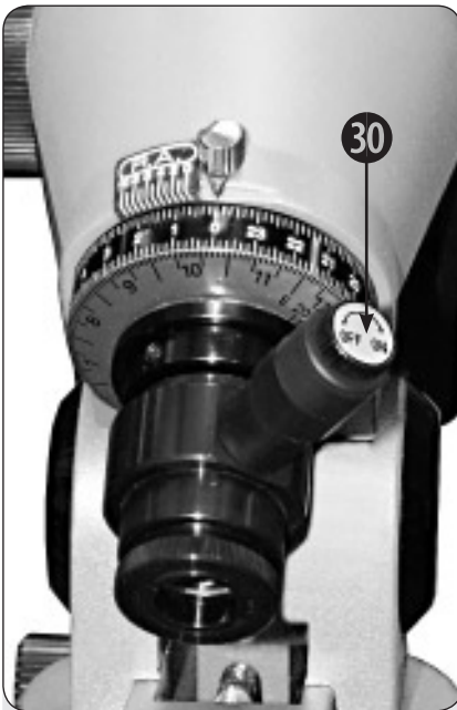
Abb. 37: Detailansicht Polsucherfernrohr mit Dreheschalter (ON/OFF)
