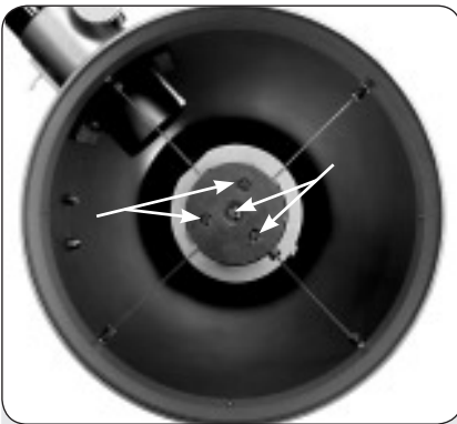
Abb. 31b: Die vier Kollimationsschrauben im Fangspiegelgehäuse
